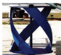
Figure I-8 : Hydrolienne à axe vertical, turbine Gorlov [39]
