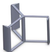
Figure I-7 : Hydrolienne à axe vertical, turbine Darrieus [36]
