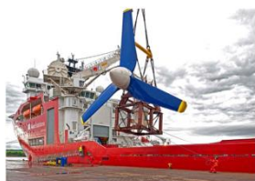
Figure I-6 : Hydrolienne à axe horizontal [40]
