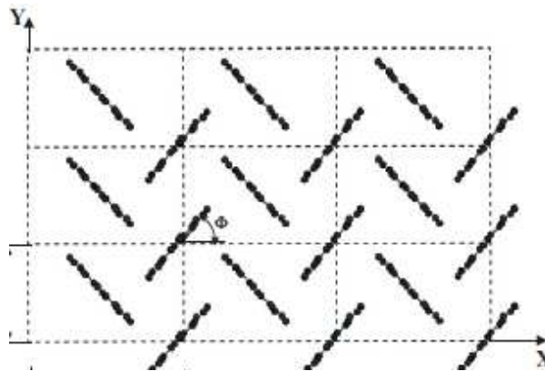
Structure cristalline chevrons de PPV dans les directions X et Y. Où \Phi = 52^\circ
