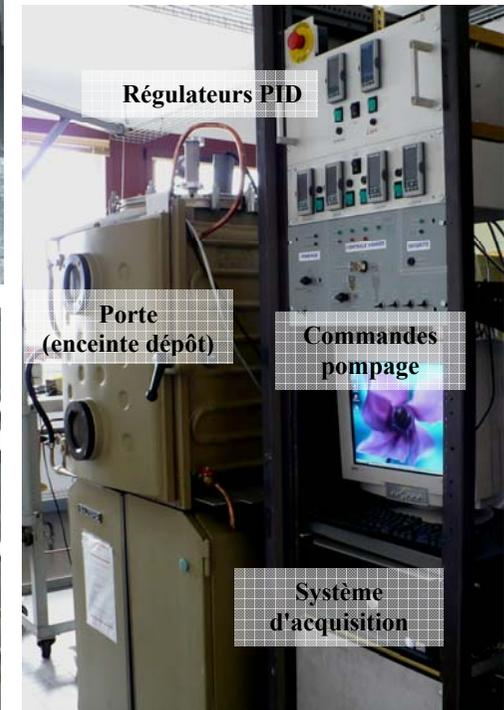
Figure 2.1 : Schéma de l'enceinte de dépôt comprenant les boucles de régulation de température (à gauche) et les photographies associées (à droite).
