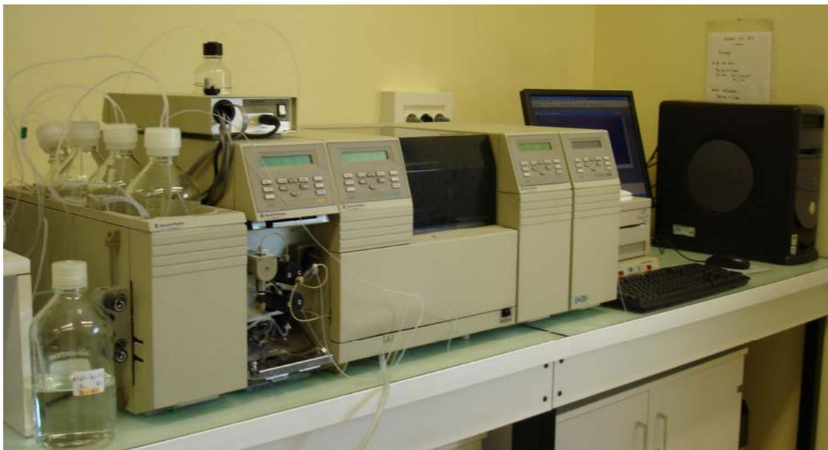
Fig 7 : Chaîne chromatographique Spectrapysics
