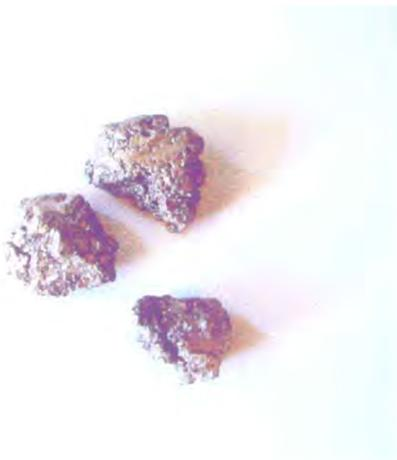
Fig. 3 : Image d'un plot (diamètre 30mm, 40g) de titane prêt à couler.
