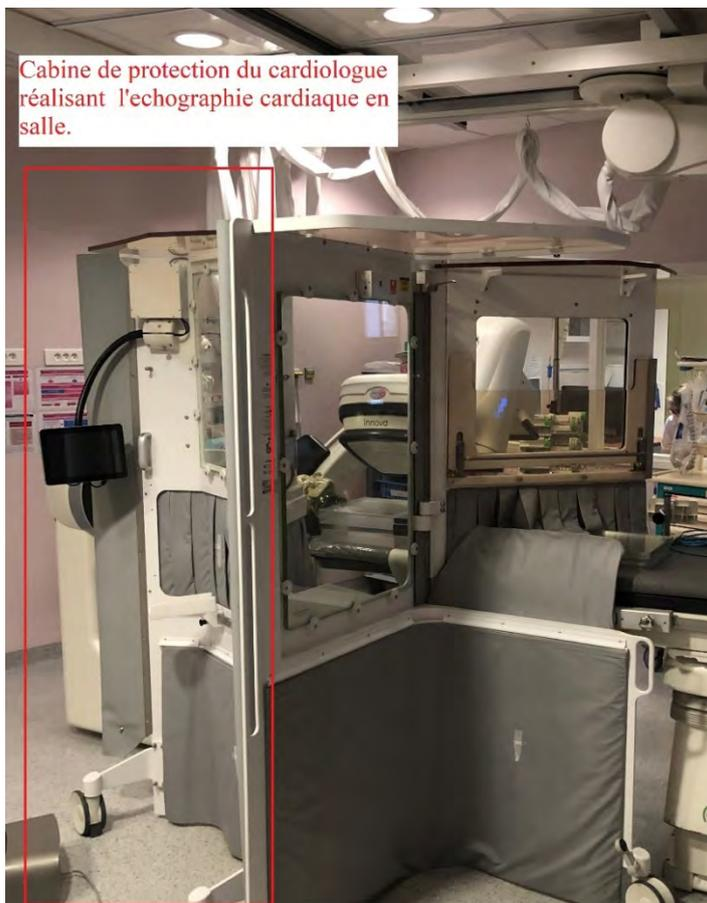
*Illustration (7) : Cabine de radioprotection de l'échographiste en salle – EchoSafe\**
