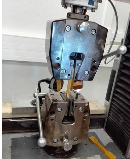
Figure II-24. Montage d'un essai de traction d'une éprouvette instrumentée
