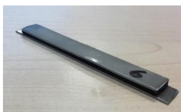
Figure IV-1. Exemple d'une éprouvette pour réaliser des mesures gravimétriques lors du vieillissement et qui sera instrumenté pour réaliser des mesures d'indice de réfraction lors de la mise en œuvre
