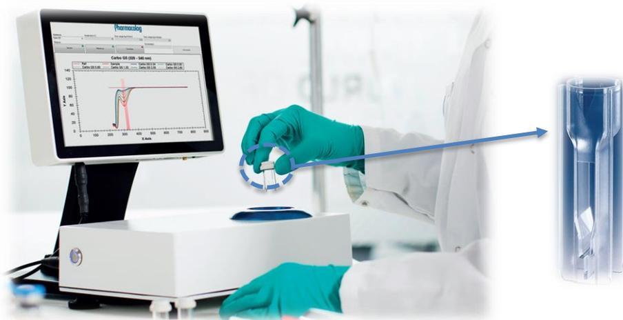
Les cuvettes servant à l'analyse sont des cuvettes à usage unique, munies d'un capuchon. Elles possèdent une contenance comprise entre 70 et 850µL. Le plastique utilisé est un mélange de polymères d'oléfines cycliques et linéaires (COC = *Cyclic Olefin Copolymers*), transparent et amorphe.
