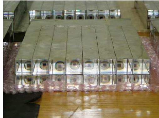
FIG. 2.10 – Détails de PHOS : à gauche un cristal PWO seul, à droite assemblés en un module EMC.
