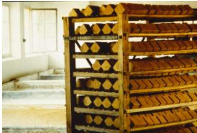
**Figure 39: Savons séchant sur des canisses (90)**
