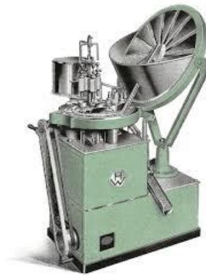
Figure 34 Modèle DH pour cachets scellés [29]
