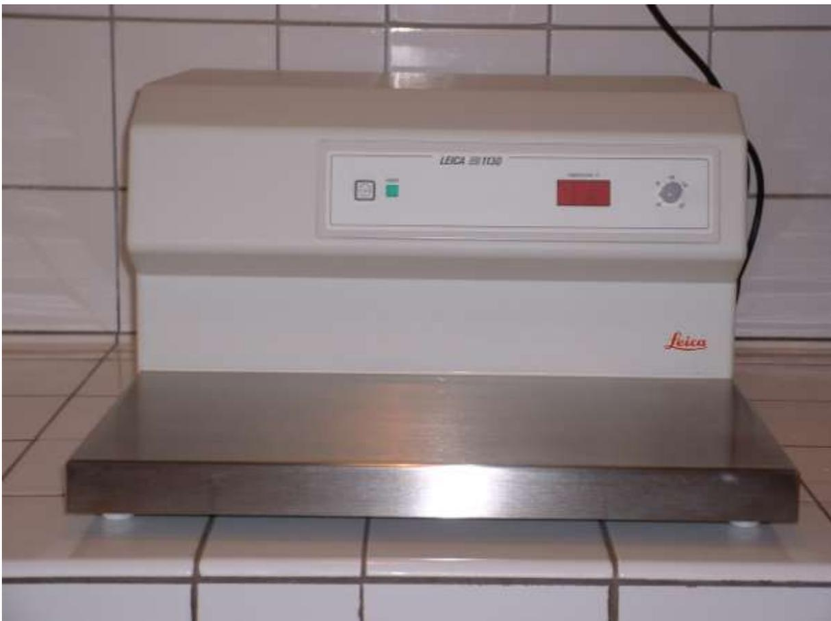
Figure 9 : Plaque réfrigérante
