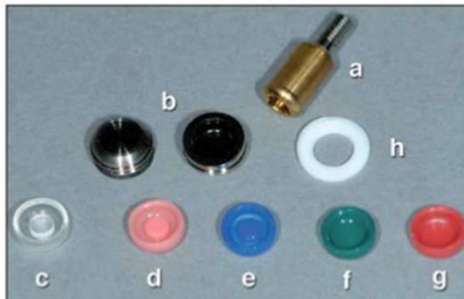
*Figure 14. Différents composants de l'attachement Locator (36) ( a : pilier-matrice ; b : capsule métallique avec patrice noire pour les étapes de mise en place ; c : patrice transparente pour forte rétention ; d : patrice rose pour rétention légère ; e : patrice bleue pour rétention très légère ; f : patrice verte pour angulation <20°, rétention forte ; g ; patrice rouge pour angulation <20°, rétention très faible ; h : anneau souple de protection du pilier)*
