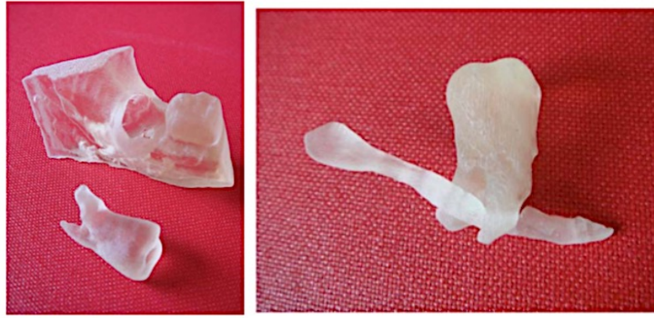
Figure 64 : Prototype imprimé par Polyjet
