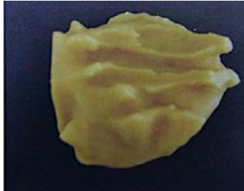
Figure 35. : Modèle "Cire" d'un obturateur maxillaire obtenu par impression Polyjet
