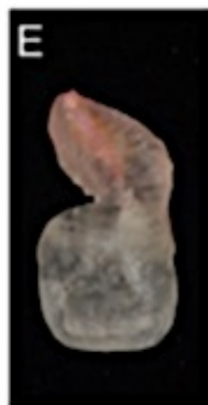
Figure 55 : Impression 3D Polyjet de la dent avec coloration du canal à l'aide d'une teinture rouge
