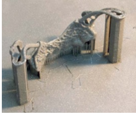
Figure 26 : Châssis métallique sur son support imprimé par SLM
