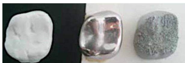
Figure 42 : Couronne SLA - Couronne SLM avec finitions - Couronne SLM Brut
