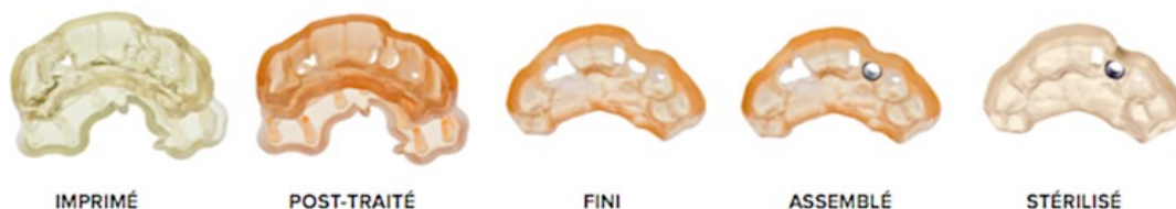
Figure 44 : Etapes successives de création d'un guide implantaire par impression 3D
