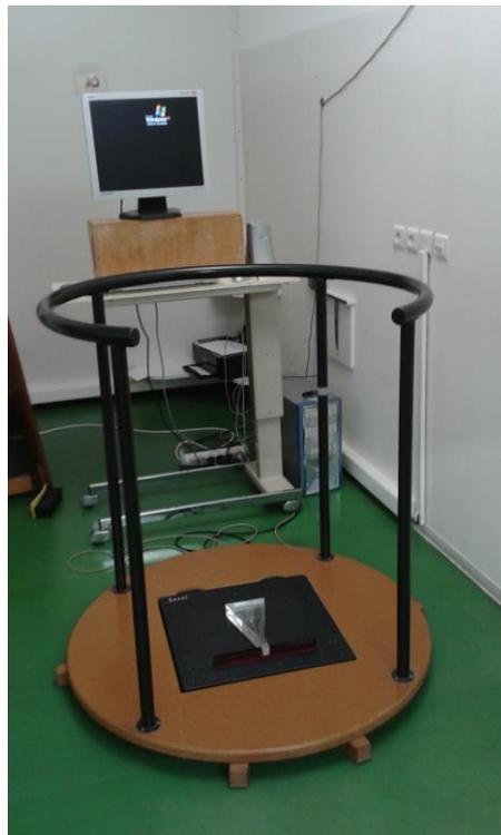
*Image 2 : Stabilomètre SATEL® utilisé pour les mesures de posture*
