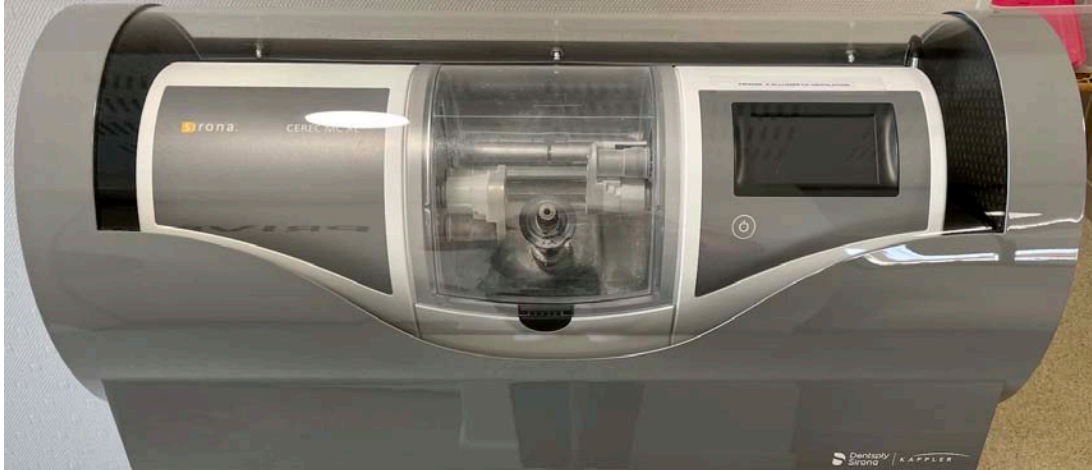
Figure 3 - Usineuse CEREC (Millet Julie)
