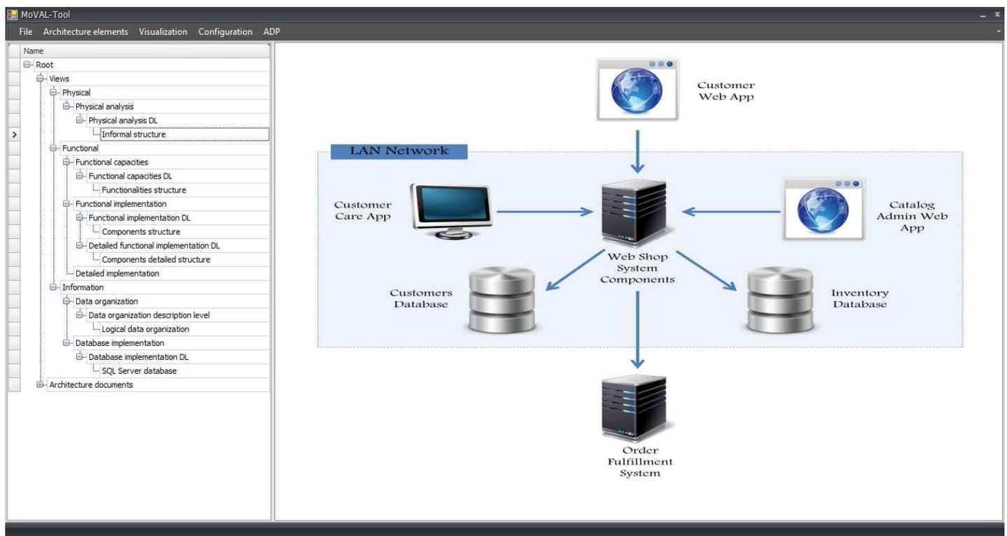
FIGURE 7.6 – L’interface graphique l’arborescence d’une architecture dans *MoVAL-Tool*.
