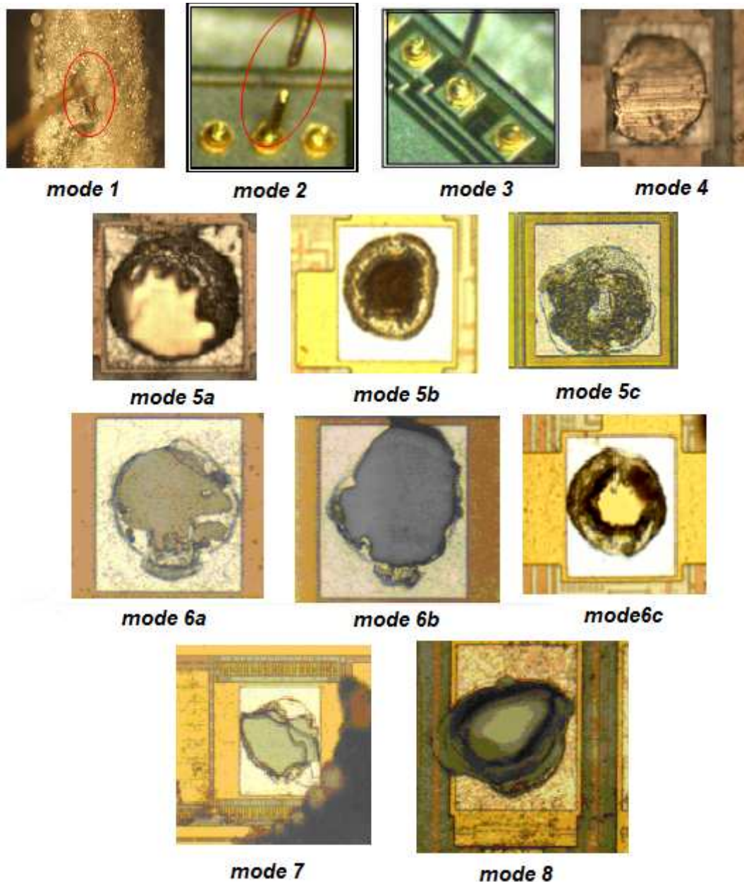
Figure II.4 : les différents modes de défaillances observés en WP et BS tests.
