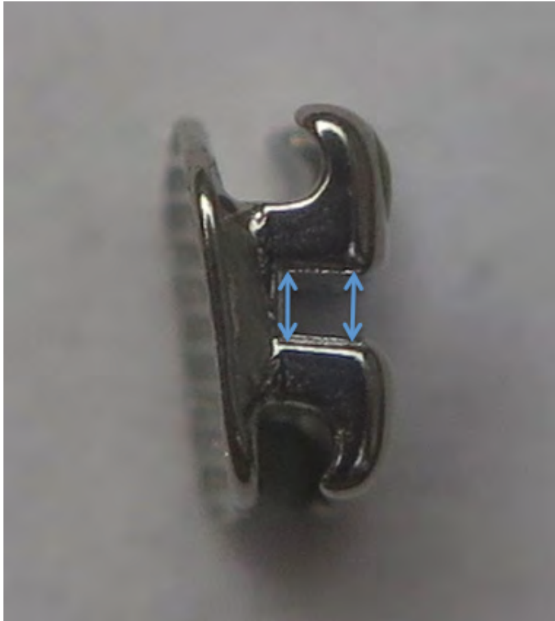
Figure 25 : Distances évaluées lors de la mesure d'un bracket de profil
