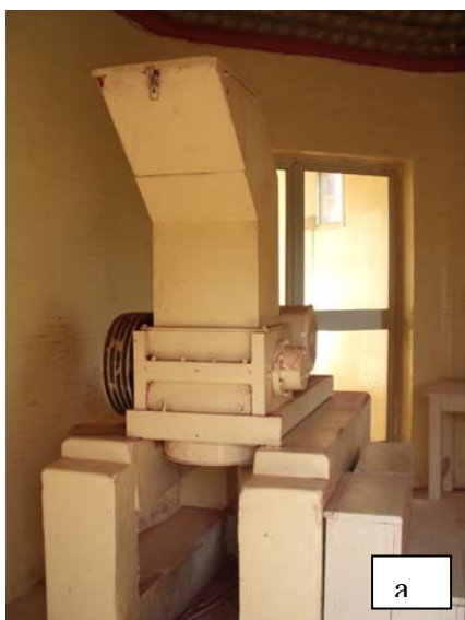
Figure 37 : broyage des plantes : a) broyeur à couteau, b) broyeur à marteau
