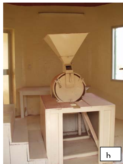
Figure 37 : broyage des plantes : a) broyeur à couteau, b) broyeur à marteau
