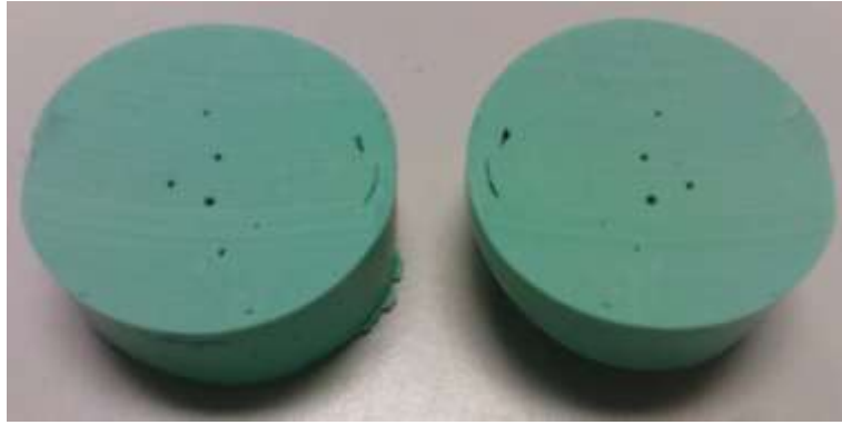
Figure 29 : Coupe transversale d'un bloc de silicone malaxé manuellement. G.N.
