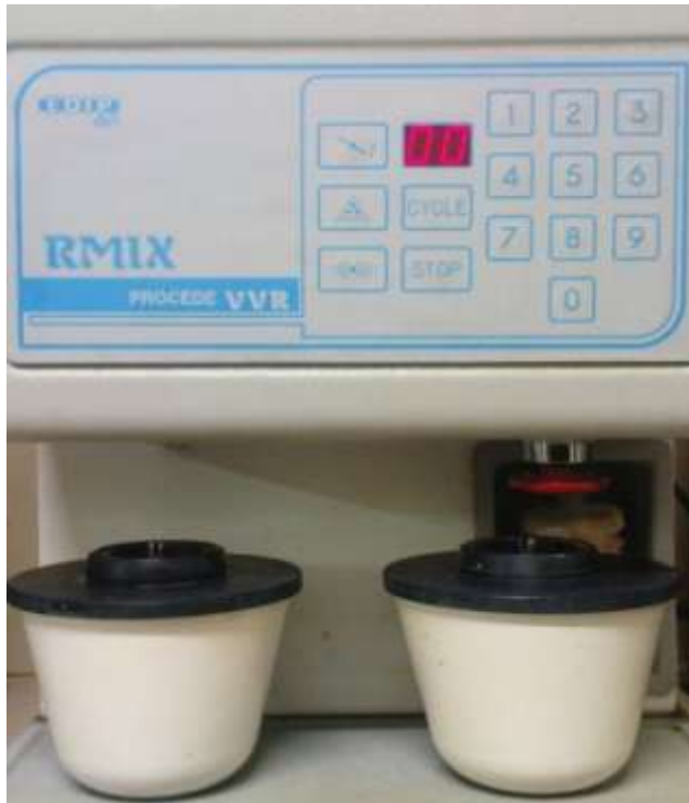
Figure 18 : Le système de malaxage par vibrospatulation sous vide RMX® et son godet mélangeur à pales. G.N.
