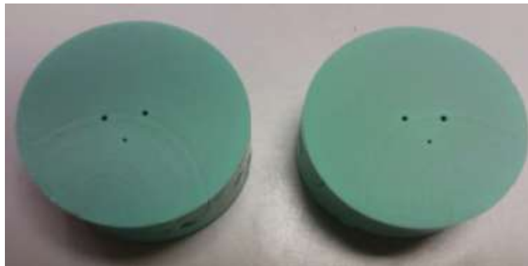
Figure 28 : Coupe transversale d'un bloc de silicone malaxé par le GMIX®. G.N.
