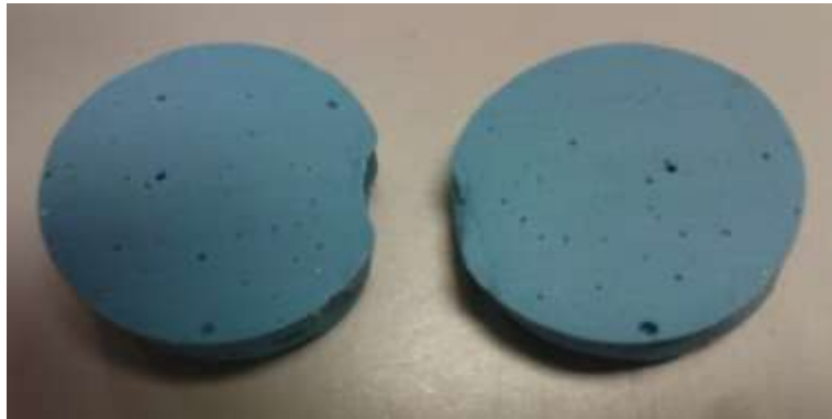
Figure 31 : Coupe transversale d'un bloc d'alginate malaxé manuellement. G.N.
