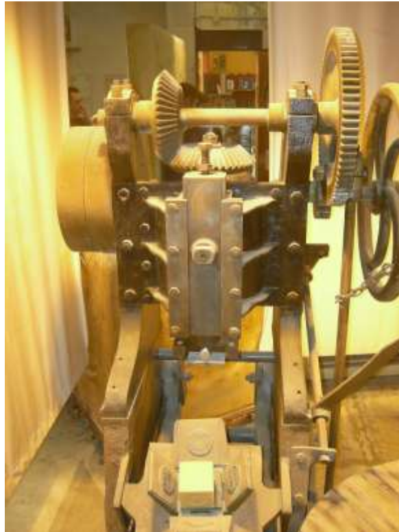
Figure 46 : La mouleuse frappeuse électrique utilisée dans les usines Fabre depuis le début du XXe jusqu'en 1990. Collection personnelle de Madame C. Couteau.
