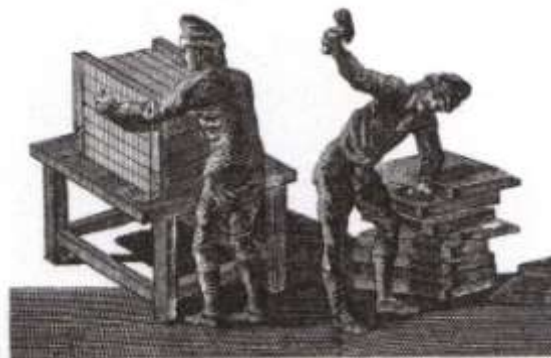
Figure 37 : Gravure représentant le découpage du savon dans un caisson et l'apposition du sceau (41).
