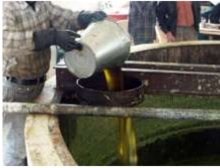
Figure 77 : Addition d'huile de laurier en fin de saponification Extraite du site internet : derm-alep.com
