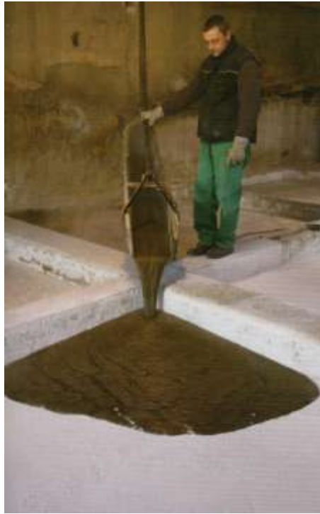
Figure 44 : Coulée du savon des les mises à l'aide de la "goulotte" articulée (59).
