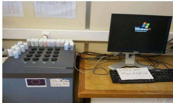
Figure II-1 : Dispositif de microcalorimétrie isotherme.
