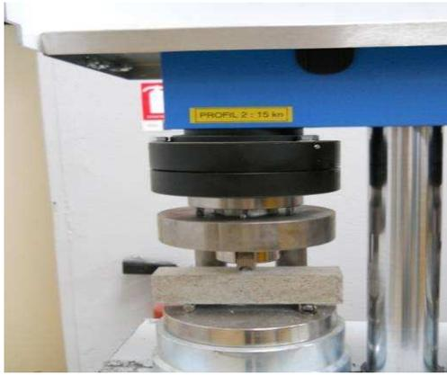
a. Essai de résistance en traction
