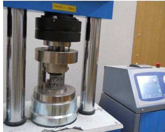
b. Essai de résistance en compression
