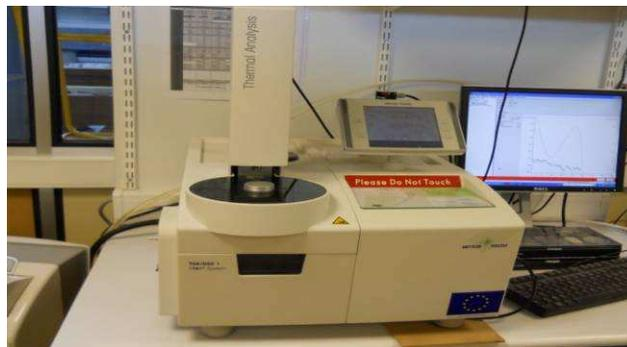
Figure II-2 : Appareil d'analyse thermo gravimétrique (ATG).
