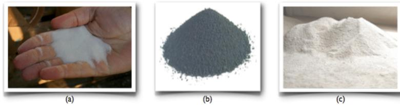
Figure I.2.1 – Exemples de charges utilisées dans les CMO : (a) microbilles de verre, (b) noir de carbone (c) silice [1].
