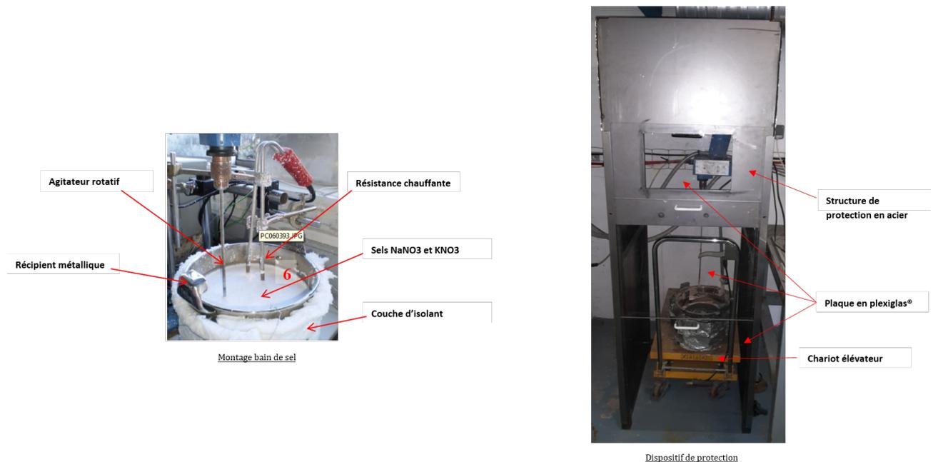
Figure II.2.3 – Dispositif expérimental.
