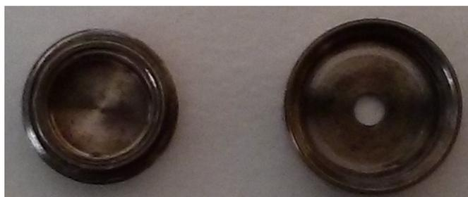
Figure III.2.3 – Coupelle DSC haute pression Perkins Elmer.
