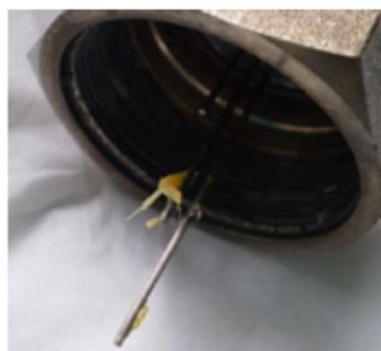
Partie supérieure avec thermocouple intégré
