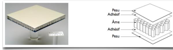
Figure I.2.7 – Une structure sandwich et ses éléments constitutifs [3].
