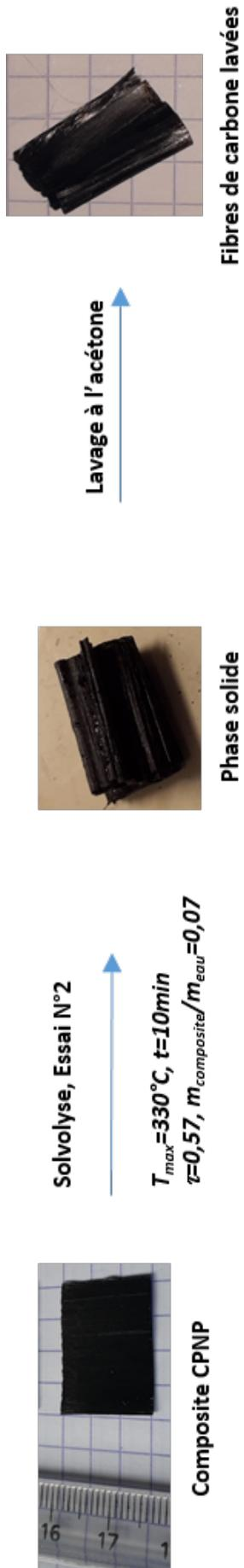
Figure II.3.13 – Produits de solvololyse du composite CPNP.
