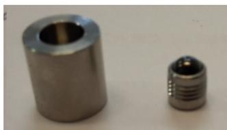
Figure III.2.5 – Coupelle DSC haute pression.
