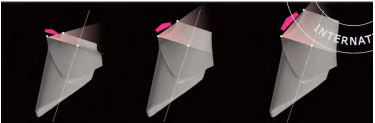
Figure 36 : Vecteur force exercé sur les tissus en fonction de l'enfouissement de l'implant
