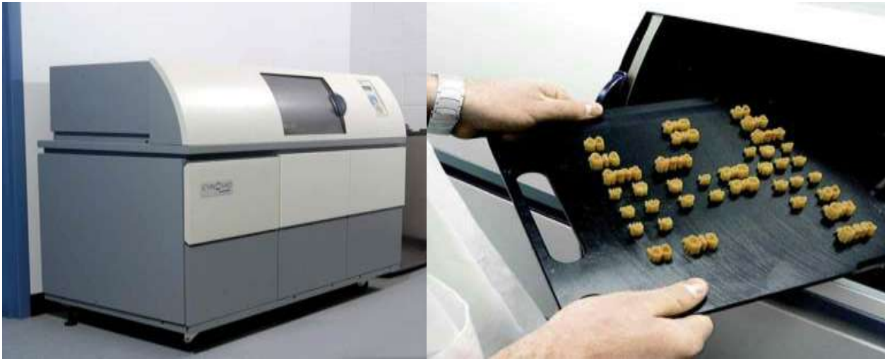
Fig. 46 : imprimante WaxPro® de Cynovad® (à g.) et les maquettes en cire réalisées [33]
