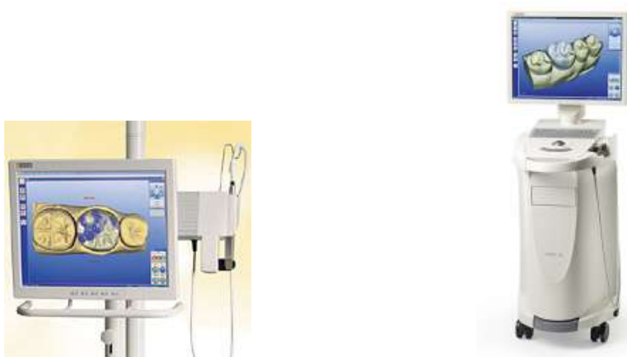
Fig. 35 : Cerec Chairline®, intégrée à l'unité (à g.) et unité de prise d'empreinte Cerec 3 [122] http://www.sirona.fr/ecomaXL/get_blob.php?name=pi_cerec_screen_174.jpg
