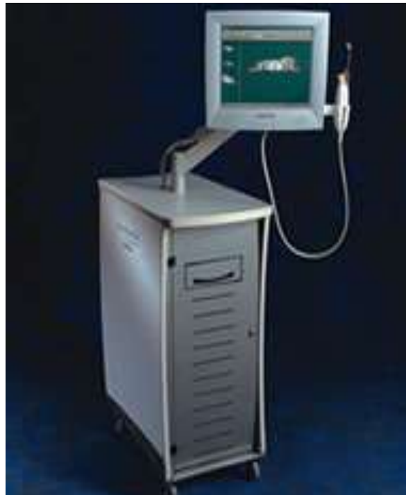
Fig. 59 : chariot comprenant le module de balayage, l'ordinateur et l'écran [99]
