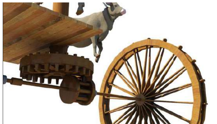
Figure 102 – RESTITUTION DE LA LIBURNE – SYSTEME PROPULSEUR – ANONYME
