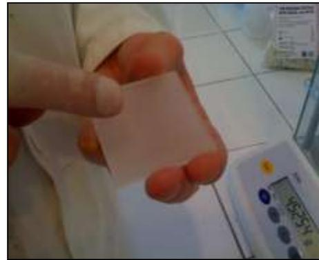
Figure 75 : Dépôt et étalement du produit sur la plaque de PMMA
