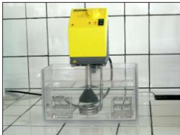
Figure 93 : Système expérimental de détermination *in vitro* de la résistance à l'eau d'un produit solaire
