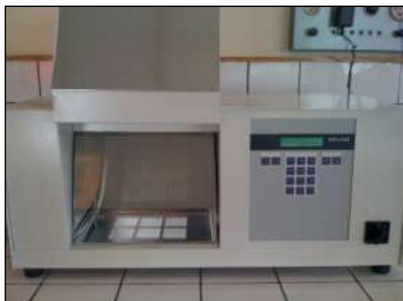
Figure 81 : Simulateur solaire Suntest CPS+
