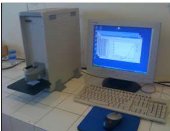
**Figure 78 : Spectrophotomètre à sphère d'intégration**
