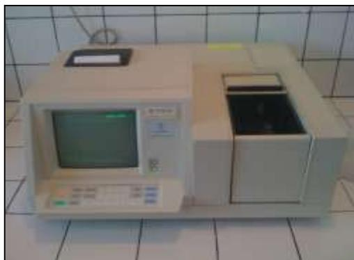
Figure 106 : Spectrophotomètre à double faisceau, Hitashi UV-visible, U-2000
