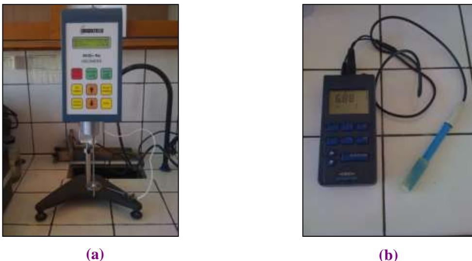
Figure 98 : Viscosimètre DV-II+ (a) et pHmètre pH/Cond 340i (b)
