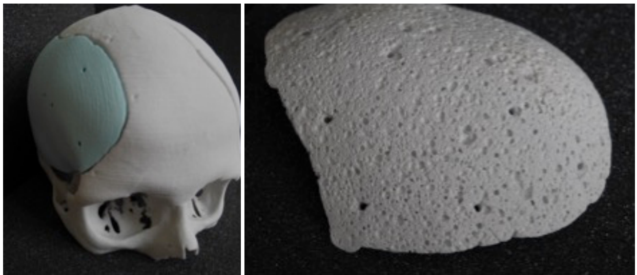
Figure 1 : Prototype (à gauche) et implant (à droite) d'une prothèse CustomBone®.
