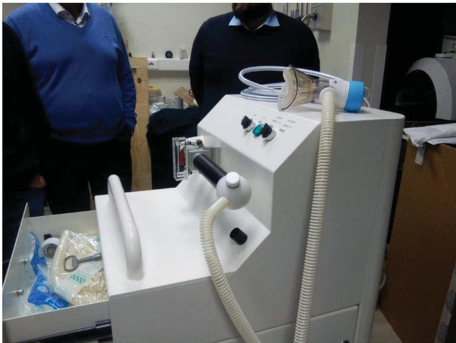
Figure 34 : Centrale d'aspiration mobile et masque double enveloppe Medicvent.
