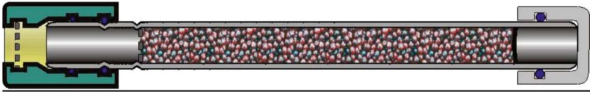
Figure 26 : Schéma illustrant un tube de prélèvement au zéolithe.
