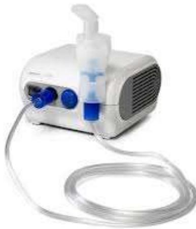
Figure 47: Nébuliseur pneumatique
