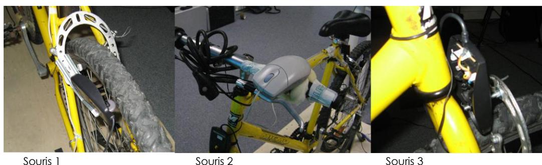
Figure 77 : Implantation des trois souris mécaniques (à boule)
