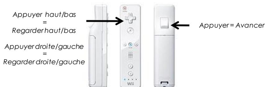
Figure 73 : Schéma d'utilisation de la Wiimote dans le monde virtuel
