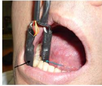
Figure 9 : Capteur fabriqué sur mesure (flèche noire : diode émettrice ; flèche bleue : photorécepteur) (Dastmalchi et al. 2012)
