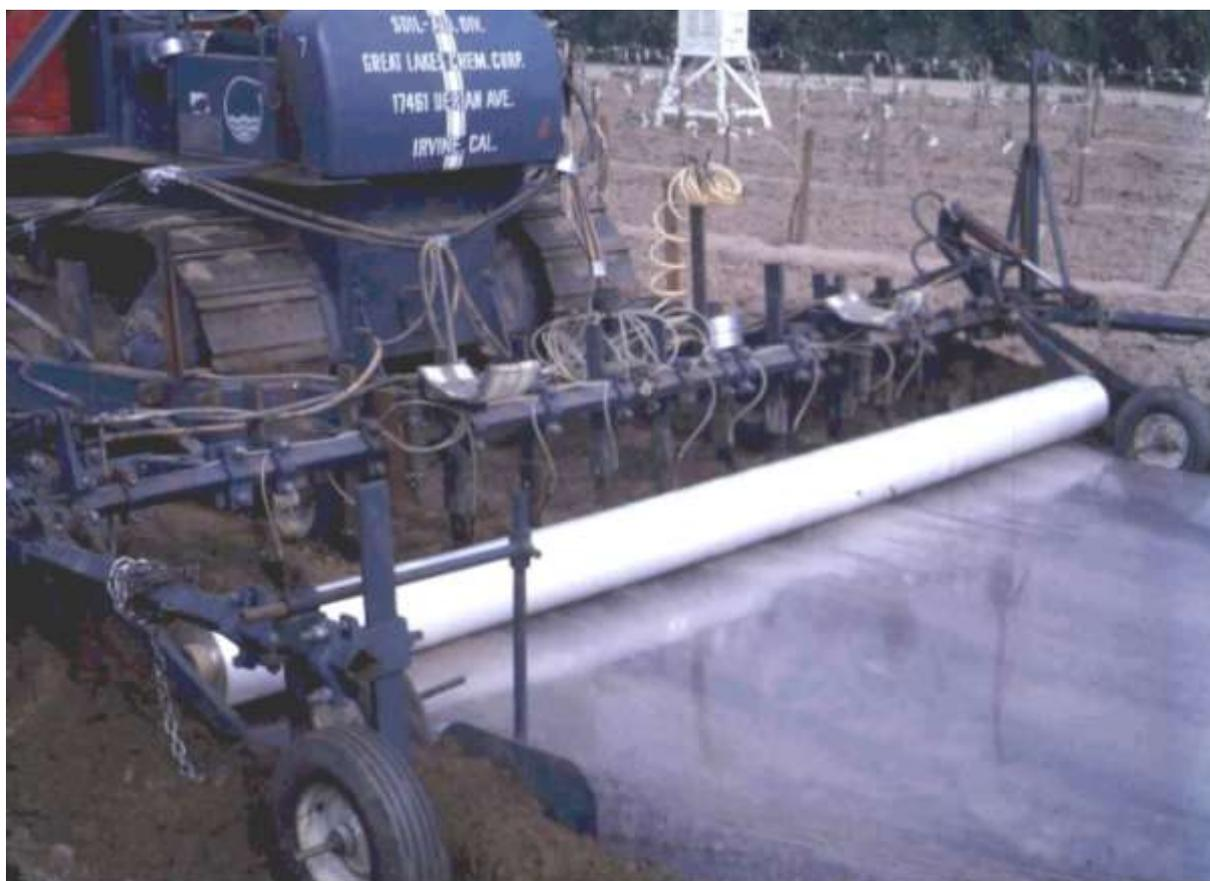
**Photo 82 : application du nématicide à l'aide d'injecteurs situés à l'extrémité de coutres, suivie d'un bâchage du sol.**
