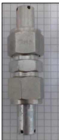
Figure II-1 : Cellule Swagelok<sup>®</sup> utilisée pour les études électrochimiques
