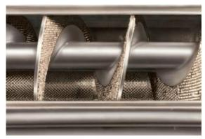
Figure 30 : Détail de la pélatrice modèle DS10 (Speciale, 2013)
