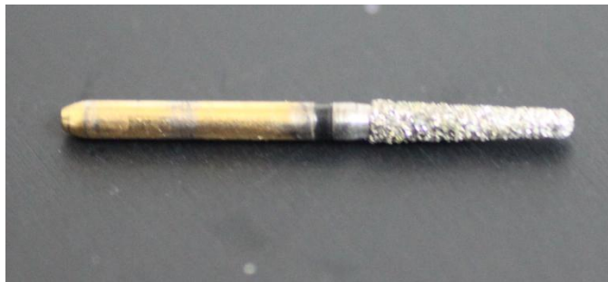
Fig. 20 Photographie d'une fraise diamantée cylindro-conique à 7°
