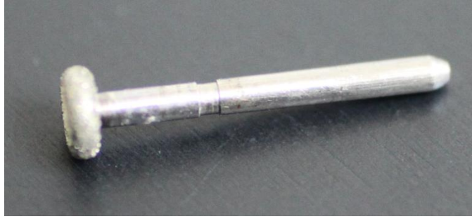
Fig. 19 Photographie d'une fraise diamantée « roue »
