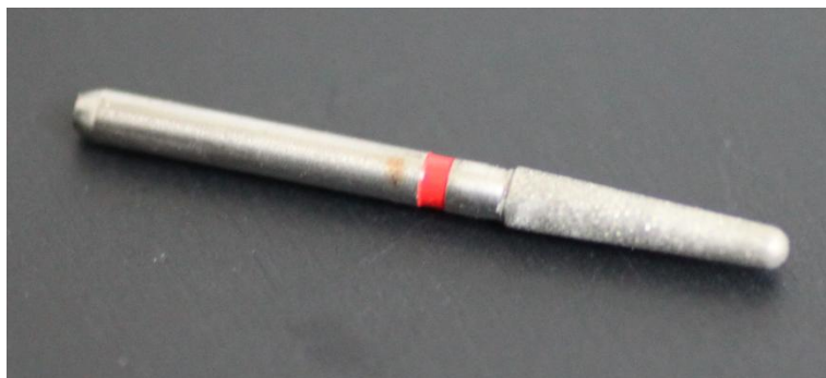
Fig. 21 Photographie d'une fraise diamantée cylindro-conique grins fins
