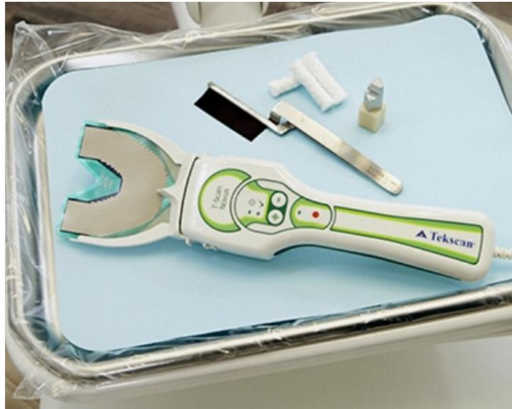
*Figure 19 : Système T-SCAN® avec le capteur sensitif, la poignée et le fil relié à la prise USB<sup>(20)</sup>*
