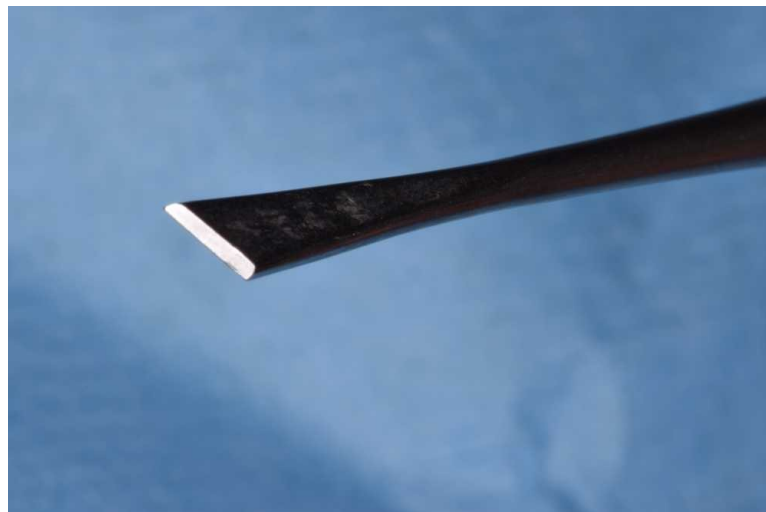
Illustration 19: Photo d'un décolleur avec l'extrémité tranchante en biseau
