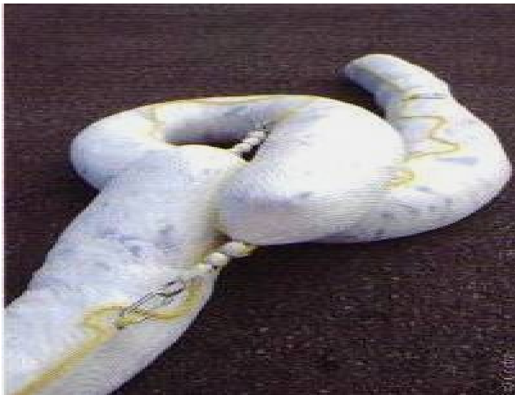
Photo N°36 : Barrage absorbant en boudins reliés avec chevauchement
