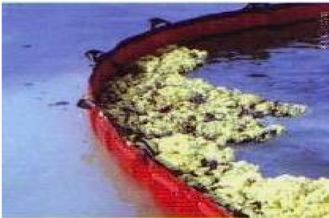
Photo N°37 : Barrage flottant déployé pour le confinement d'une nappe sur le plan d'eau à l'aide d'absorbant en vrac
