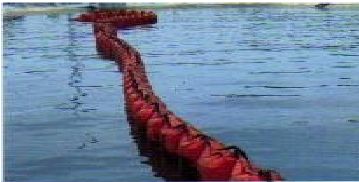
Photo N°35 : Barrage flottant déployé sur le plan d'eau
