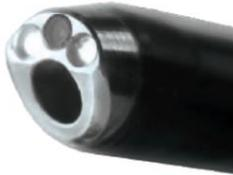
*L'extrémité de l'urétéroscope est composée de 2 faisceaux lumineux, du canal opératoire et du faisceau de fibre optique.*
