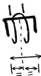
FIGURE 5.2 – Installation d'un tapis "au milieu" d'une élingue
