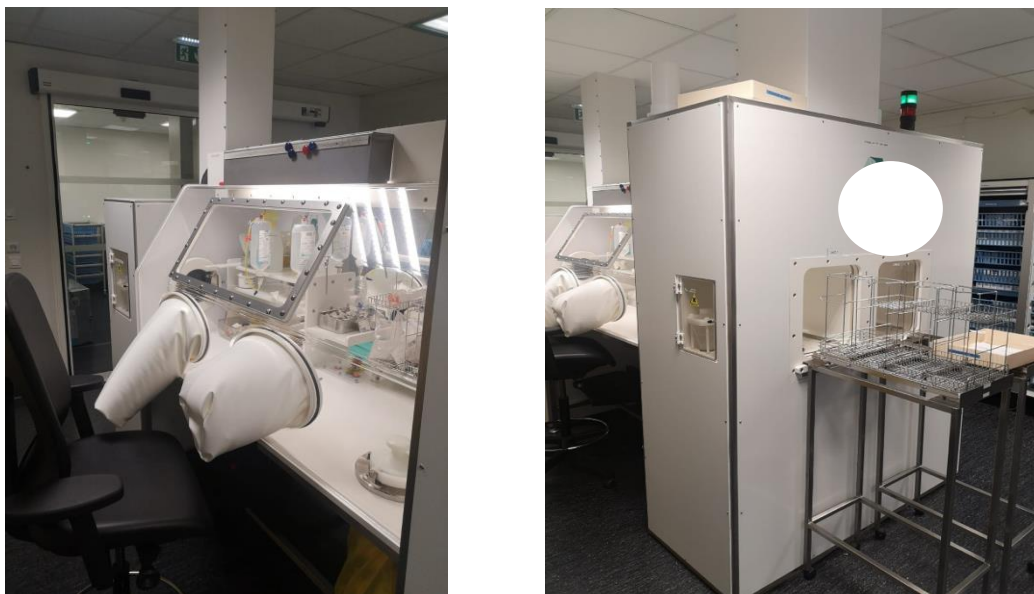
Figure 8 : Un isolateur dédié à la préparation de médicaments injectables stériles à l'UPCO.
