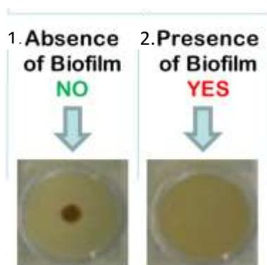
1. **Absence de biofilm**, l'ensemble des micro-particules magnétiques se regroupent sous l'influence d'un aimant, et sont visibles sous forme d'un point rouge.
