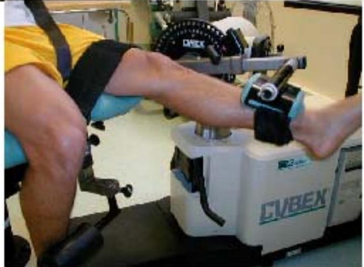
**Dynamomètre isocinétique de type Cybex Norm
