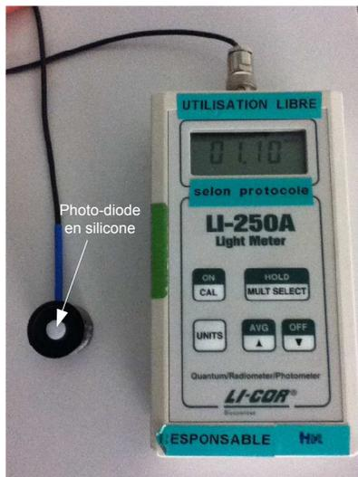
(a) Photographie du capteur LI-190-SA et du boîtier de mesure LI-250A Light Meter (LI-COR, USA)
