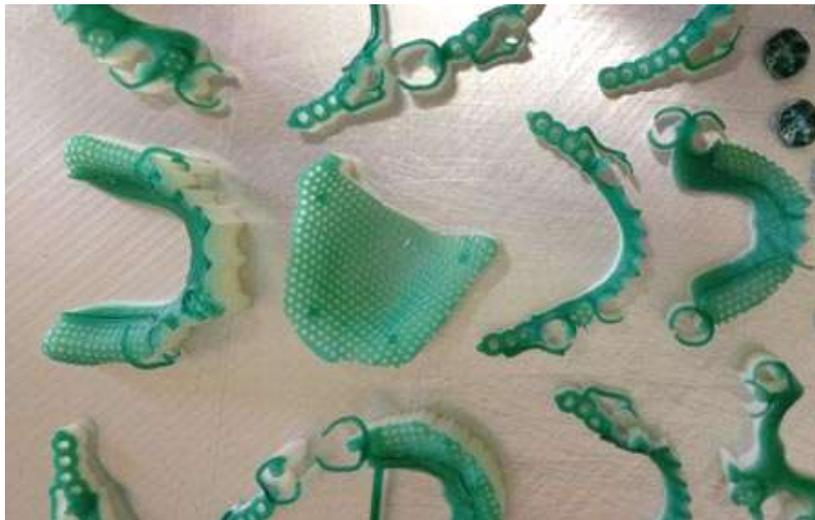
*Figure 30 : Maquettes réalisées par impression 3D
