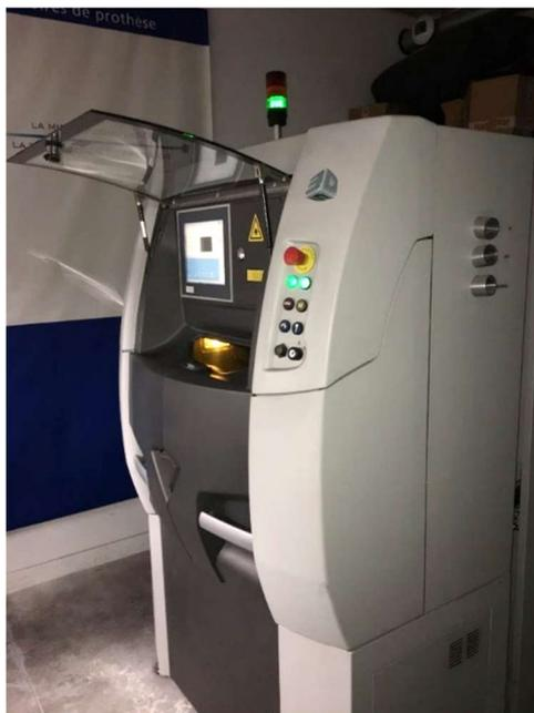
Figure 27 : Unité de production 3D par micro-fusion LASER – Laboratoire Bongert / 3DRPD
