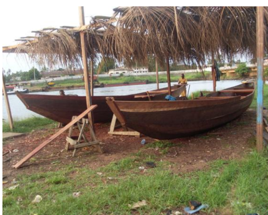
Photo 3 : Grande pirogue en planches en construction à Kribi (Cameroun)
