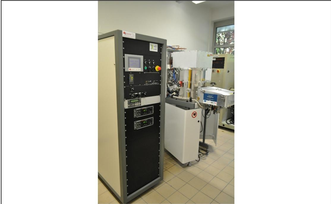
Figure II.4 : Dispositif de pulvérisation cathodique magnétron utilisé pour le Mo et l'Al.
