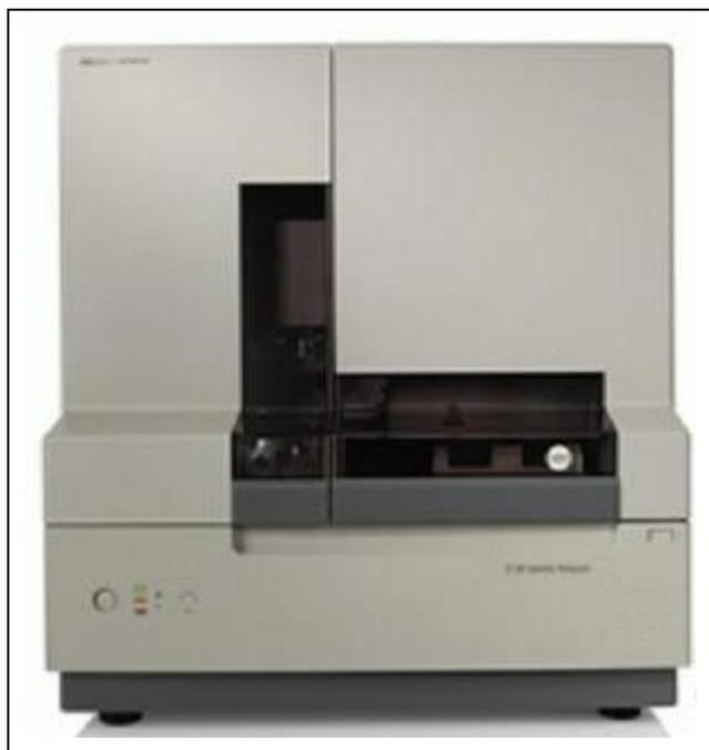
Figure 27 - Le séquenceur ABI prism 3130® utilisé pour l'étape de séquençage capillaire
